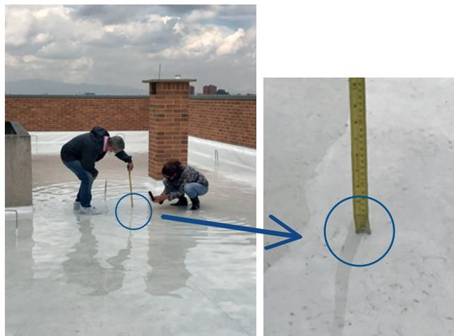
La inundación debe mantenerse hasta el nivel indicado un máximo de 24 horas. Los desagües deben cerrarse mediante un sistema que permita mantener el nivel requerido. Se prestará especial atención a los efectos que pudiera ocasionar sobre la cubierta, la existencia de lluvias torrenciales, durante la realización de la prueba.
